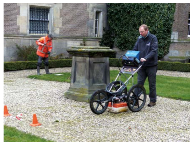
Huub Scholte Lubberink hanteert een grondboor en Martin Pieters van Geofoxx bedient de bodemradar.
